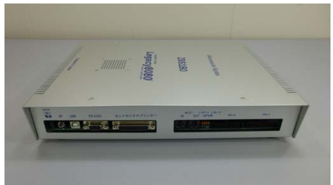
写真4 : Legacy8080 エントリーモデル 裏面 プリンタ、RS-232C、MIDI、PPI などの IF が在る
