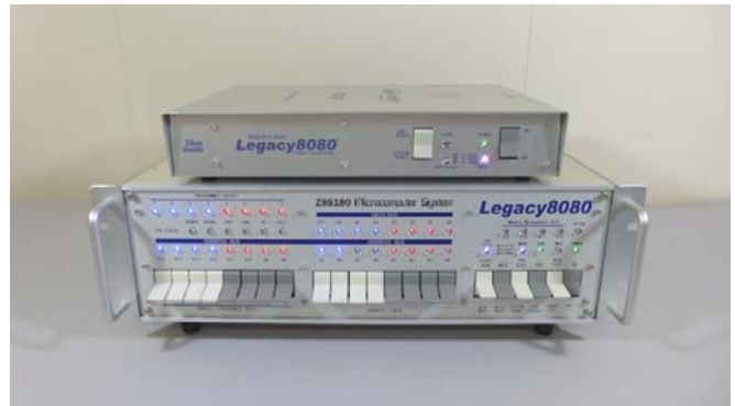
写真4 : Legacy8080 エントリーモデル 上位モデルの拡張ボックスとしての利用例
