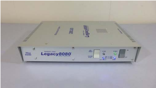
写真1 : Legacy8080 エントリーモデル 正面 横幅:330mm 奥行き:240mm 高さ:55mm 重量:1.5Kg
