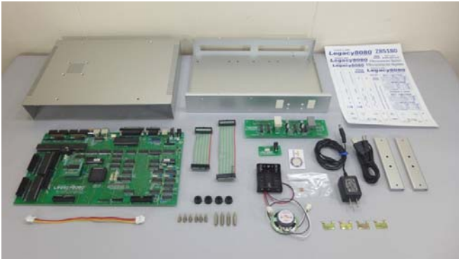
写真3 : Legacy8080 エントリーモデル セミキット セミキットに含まれる部品一式
